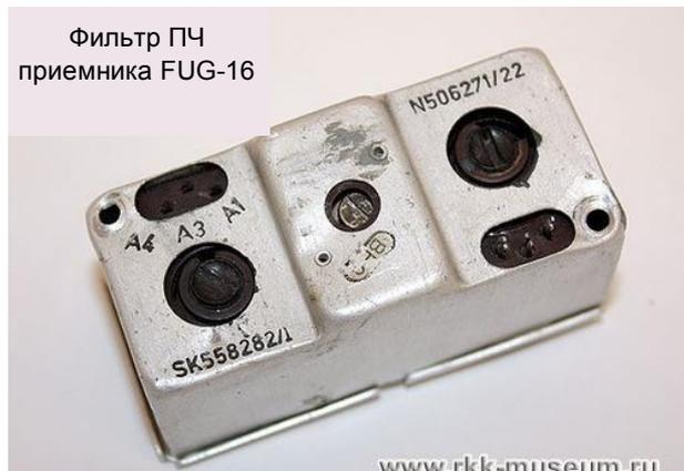
Все это позволило создать приемник в сжатых габаритах, блочной конструкции с разъемами и обеспечить легкую ремонтодоступность, заменяемость блоков и хорошую экранировку.
